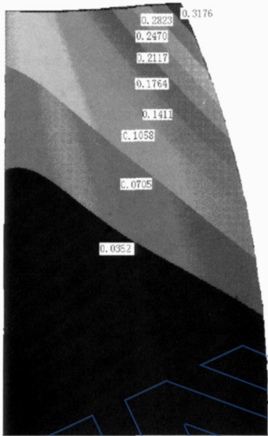
图 2 涡轮叶片结构变形 Fig. 2 Deflection of the turbine blade
